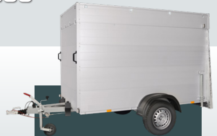
VT3 , hauteur intérieure 153cm Rainure sur 4 hauteurs différentes de série avec 6 œillets.
