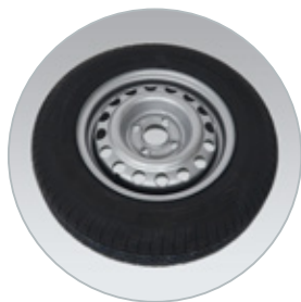
Accessoire ; roue de secours, montage possible sous le plancher
